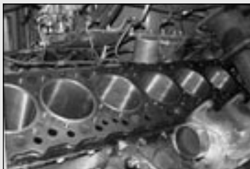
Der gereinigte Motorblock mit den neu eingezogenen Laufbuchsen wartet auf die Kolben.
