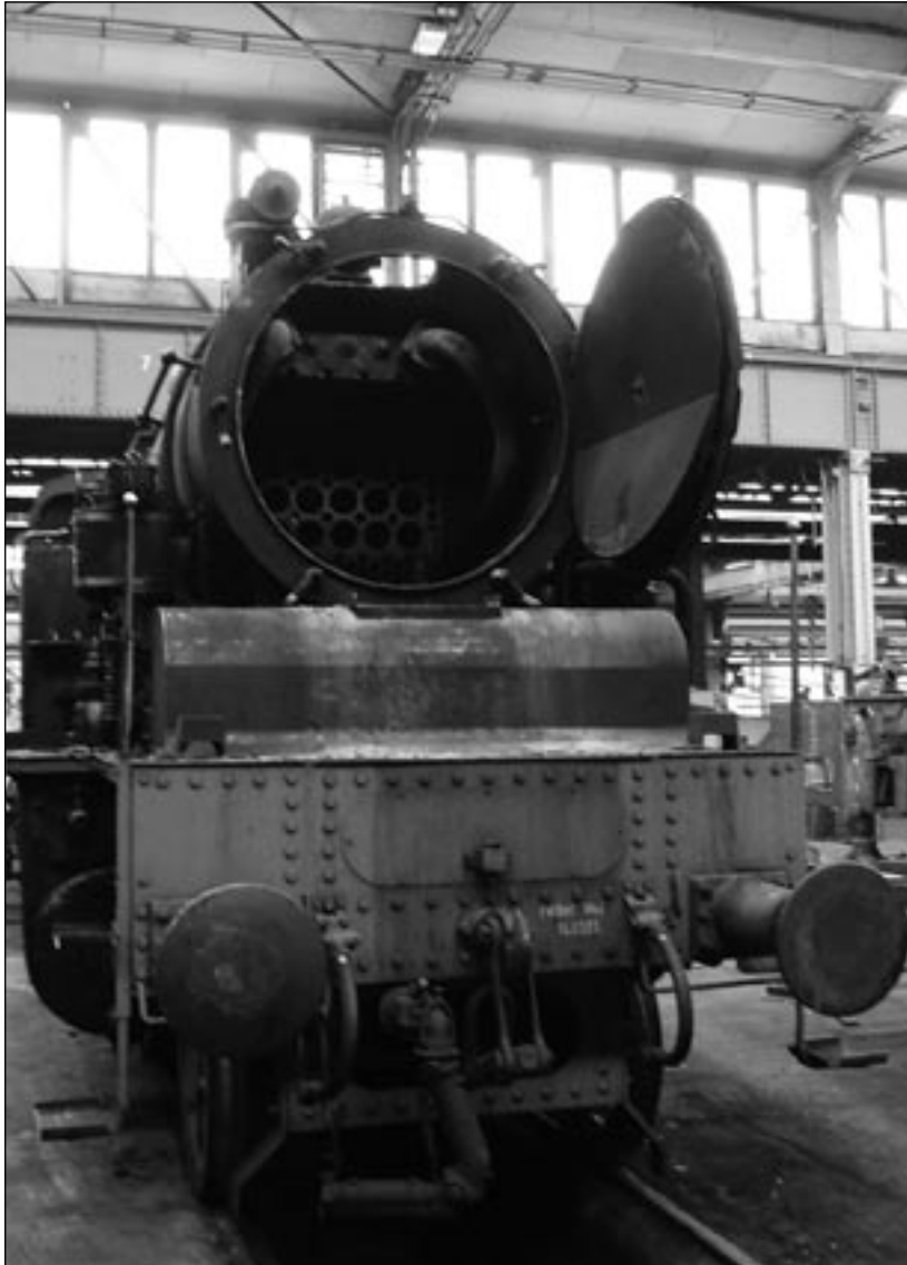
75 1118 im Dampfloswerk Meiningen - ohne Rohre und Kamin. (Januar 2006)
