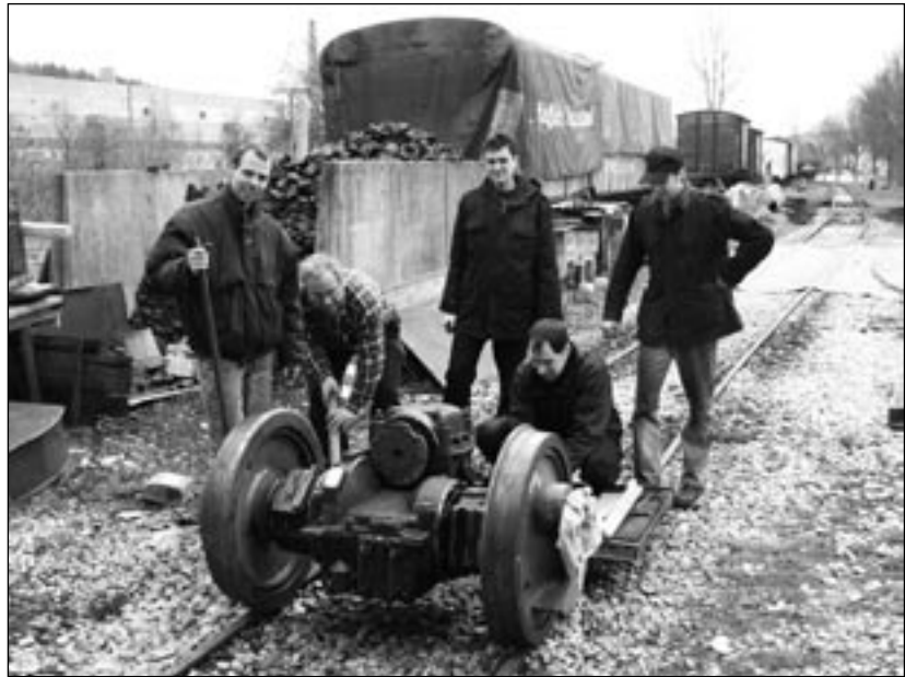
Normalerweise gut unter der Lok versteckt: der erste Radsatz mit dem Achsgetriebe.
