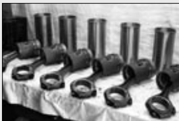
Bereit zum Einbau: Neue Laufbuchsen, Zylinder und Pleuel auf der Werkbank
