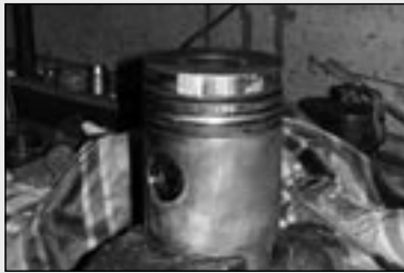
Ausgebaut: Einer der defekt gewordenen Kolben auf der Werkbank.
