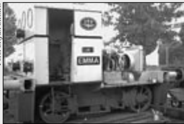
Eine der letzten OMZ 122 mit Originalmotor: 36 PS aus 11 Litern Hubraum bei 800 U/min.
