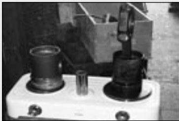
Ausbau der Pleuel/ Kolbenbolzen: Anwärmen mit der elektrischen Herdplatte
