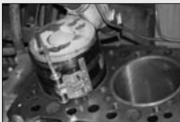
Einbau der Kolben und Pleuel mit dem aufgesetztem Kolbenring-Spannwerkzeug.
