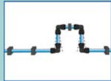
Grundsätzlich sollten Druckluftleitungen mit einem sogenannten Wasserabscheider (Schwanenhals) ausgelegt werden. Wir empfehlen hier unseren Artikel 215 2222.
