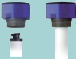
CLEARPOINT® Filterelemente werden ohne querschnittsverengenden und störenden Zuganker eingesetzt. Das reduziert einerseits den Strömungswiderstand und vermindert zudem den zum Elementwechsel notwendigen Platz auf 1/3 - besonders von Vorteil bei beengten räumlichen Verhältnissen. Das innovative Push-Fit-Design der Elemente ermöglicht ein einfaches und schnelles Austauschen.
