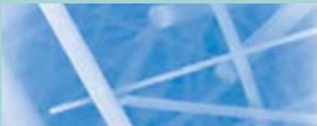
Das **Hohlraumvolumen** des Borsilikat-Filtermaterials von **96%** sorgt für geringsten Druckverlust. Herkömmliches Filtermaterial aus gesintertem Polyethylen weist lediglich ein Hohlraumvolumen von 45% auf. Damit ist die zum Durchströmen freie Querschnittsfläche bei CLEARPOINT® Filtern mehr als doppelt so groß.
