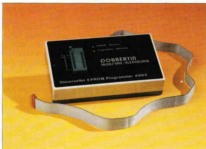
Bild 2: Ein Eprom-Programmiergerät. Mit ihm lassen sich Programme auf Eproms "brennen". Ein Start von der Kassette oder Diskette entfält.
