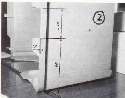
Bild 2: Günstige Platzierung des Flachbandkabels
