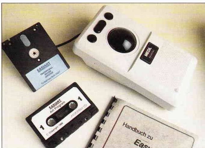
Bild 1: Die Marconi RB2-Trackball-Ausrüstung besteht aus: Trackball, 1 Kassetten- und 1 Disketten-Version von Easyart und einem deutschen Handbuch.
