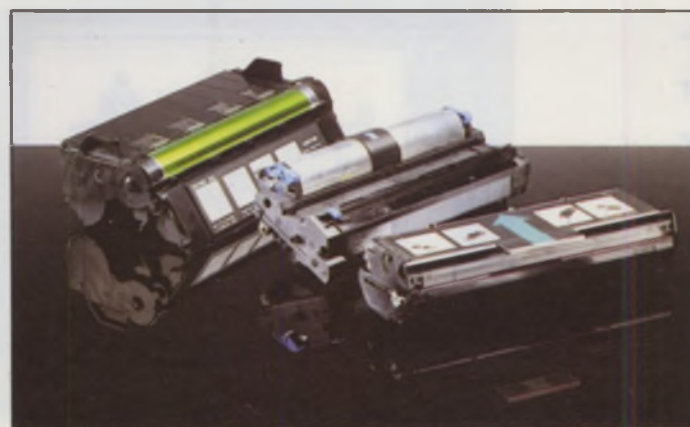
Die Entwicklungs- einheiten im Vergleich: Seikosha, Oki, Brother/HP
