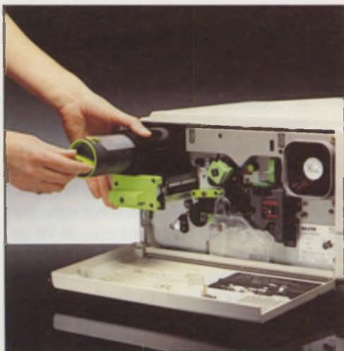
Der Sanyo zeigt einen ähnlichen Aufbau wie ein Kopierer: hier das Einsetzen des Toners
