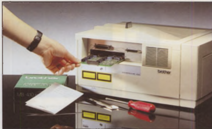
Bastelstunde: Zum Einbau von Emulations- und RAM-Karten braucht man oft Finger- spitzengefühl.
