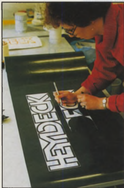
Der Rest ist Handarbeit: die überflüssige Folie wird entfernt und die geplottete Schrift freigelegt. Zur Erleichterung dieser Arbeit wurde vom Plotprogramm automatisch ein Rahmen um das Objekt geschnitten; eine Option, die in jeder Plotsoftware vorhanden ist.
