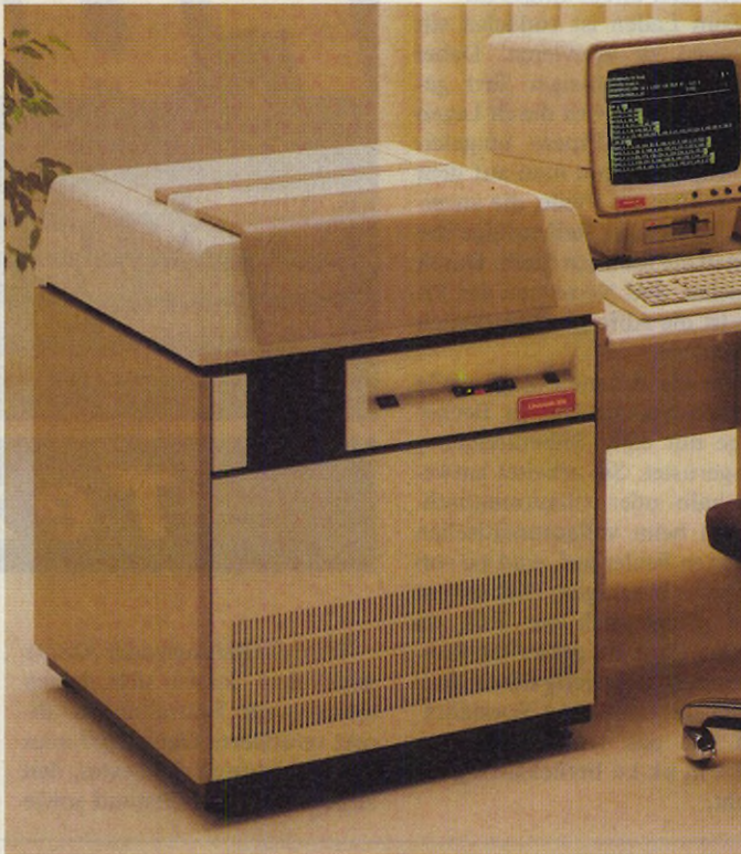
Bild 2. Dieser sperrige Würfel enthält den Laserbelichter.
