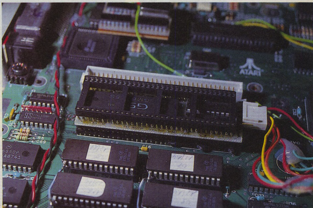
Pixel Wonder auf dem 68000er: Oben der aufgelötete Zusatzsockel; rechts Kabelanschlüsse. Beachten Sie den freien Pin am Stecker.
