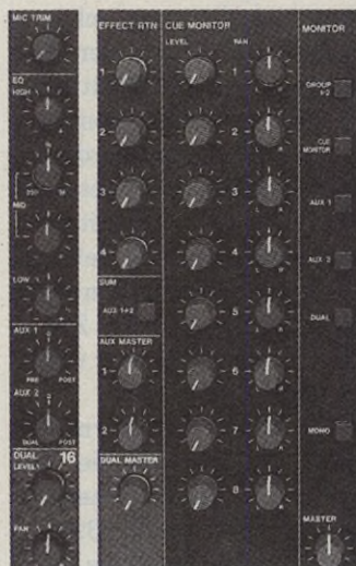
Aufbau eines Inputkanals — rechts die Master-Sektion mit Effektwegen
