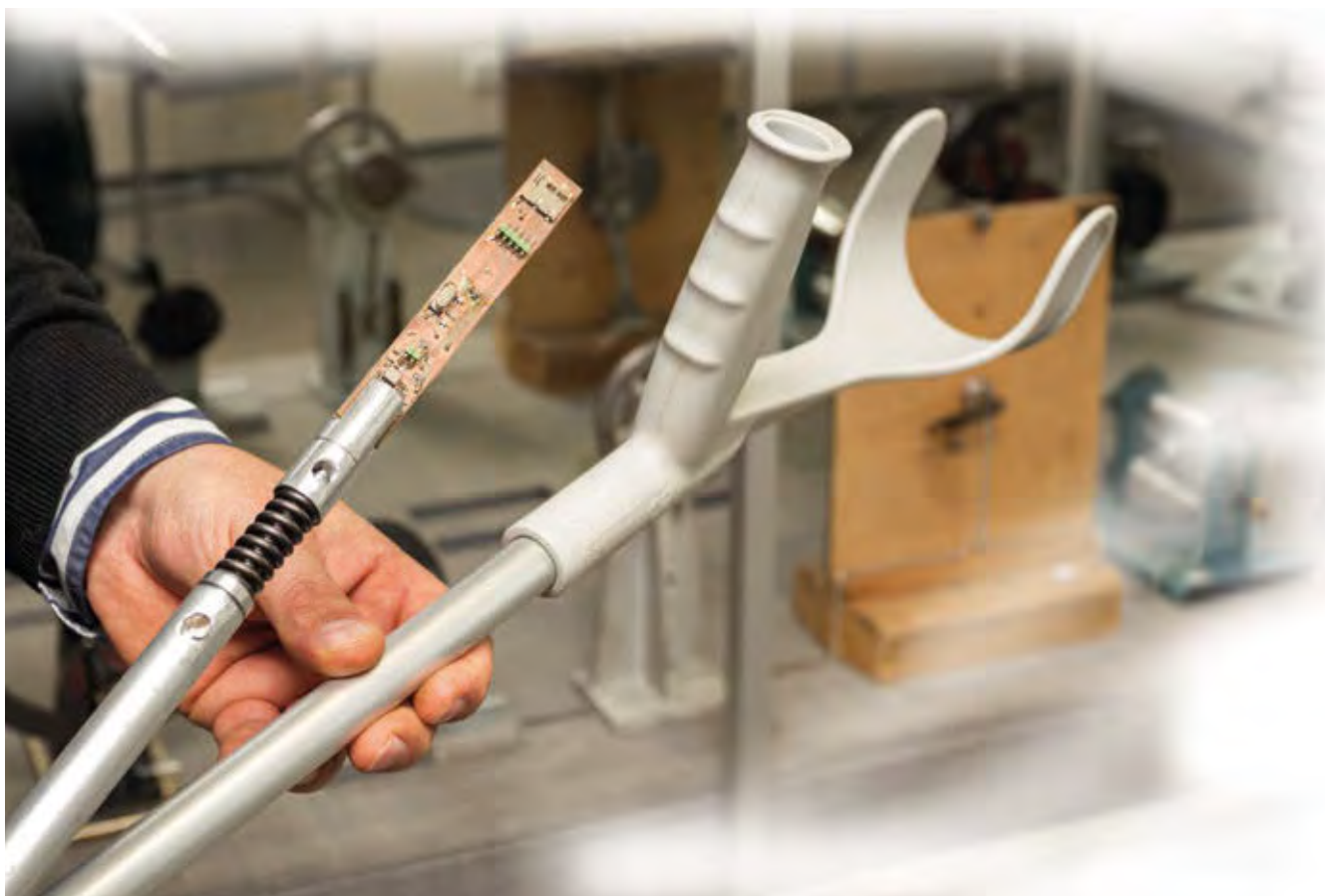
Mehhatroonika stiilinäide meditsiinist – arukas kark. Selle mälukaartile salvestuv info aitab patsiendil parema paranemise huvides kargu kasutamist korrigeerida.
