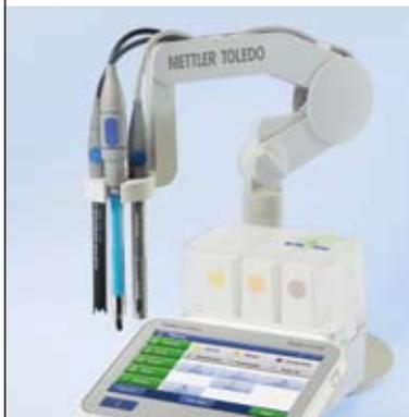
uPlace™电极支架：可单手操作电极支架；垂直上下移动电极至最佳位置。这就能够更快地测量，并降低样品容器翻倒或电极损坏的风险！
