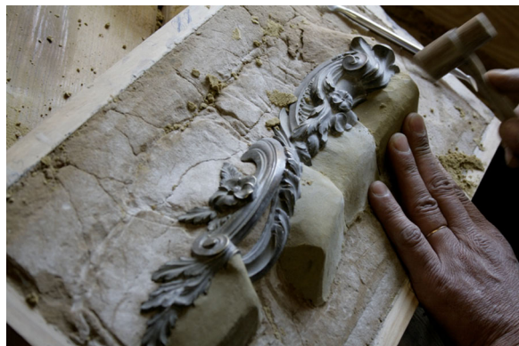
Fig. 14. Taller de la Fundición. Moldes en caja de arena. Talleres FRESS. Fotografía: Banco de Imágenes de la FRESS.
