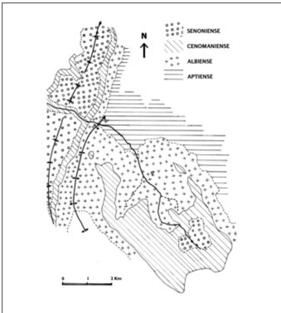
Fig. 7. Mapa geológico de la zona estudiada y sus alrededores. Confeccionado a partir del Mapa Geológico escala 1:50.000, Hoja nº 544 del Instituto Geológico Minero de España.
