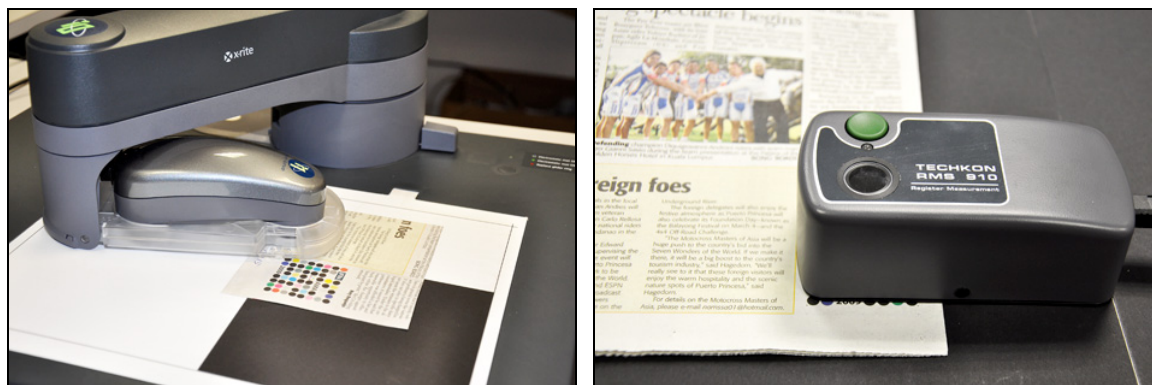
Instrumento de medida EyeOne iO de X-Rite (izda.) e instrumento de medida del registro de color RMS 910 de Techkon (dcha.)
