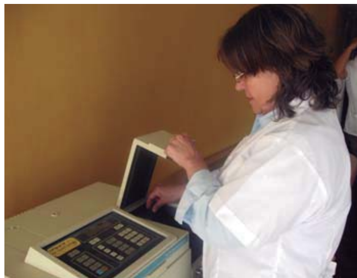
Medida de las antocianinas en la pulpa congelada de camu camu, por espectrofotometria UV-vis
