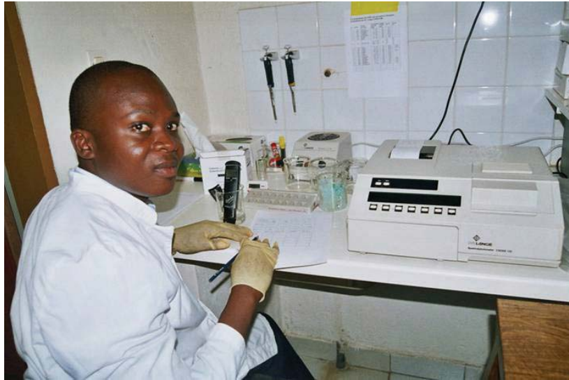
Abb. III.1.4-10: Martial Dossou führt chemische Wasseranalysen an dem Photometer CADAS100 durch
