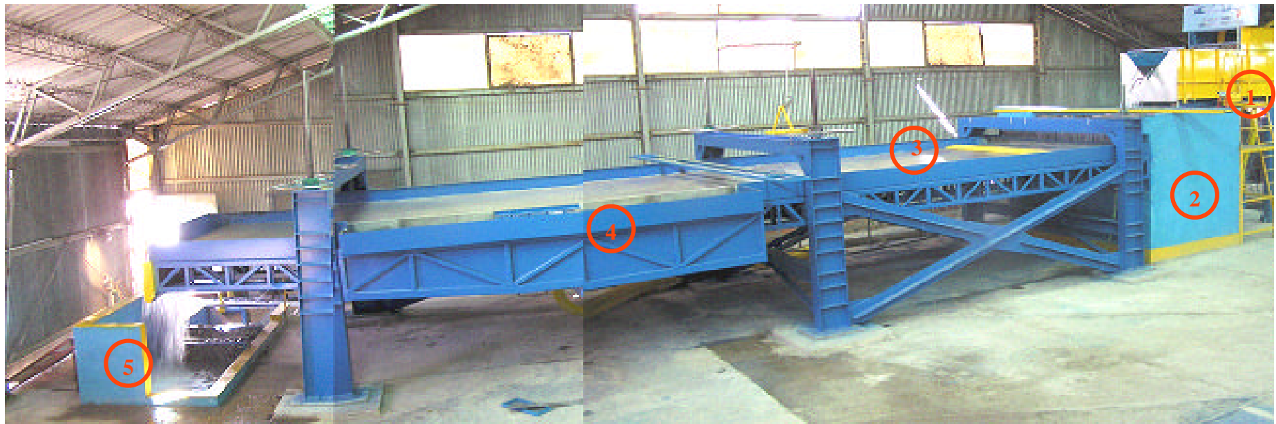
Foto N° 1: Vista General de la plataforma de experimentación de sumideros de aguas lluvias.
