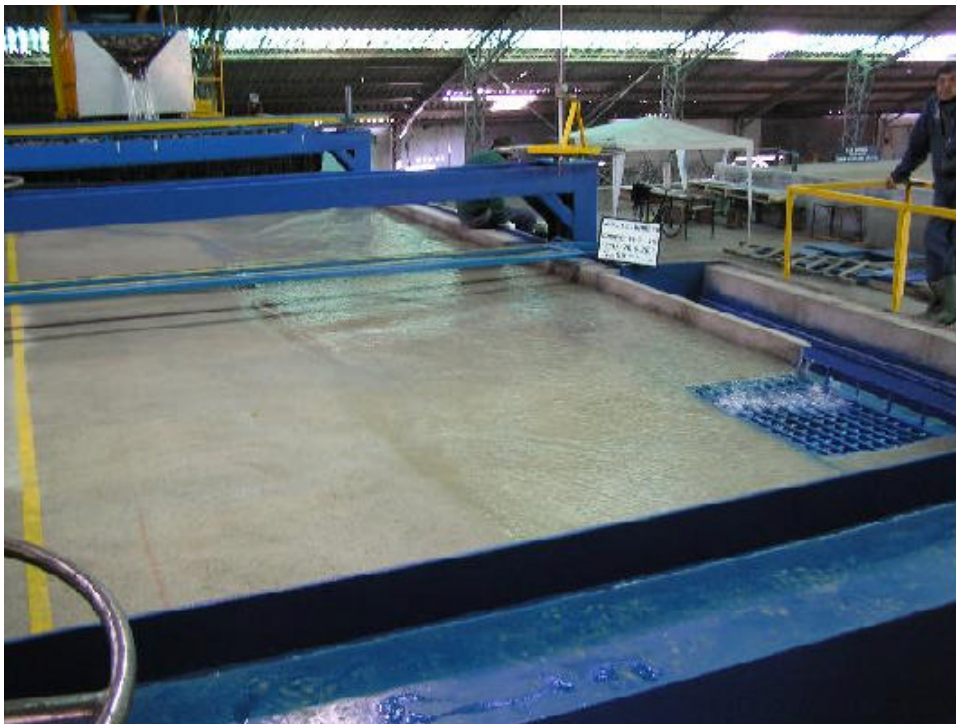
FOTO N° 4: Vista Funcionamiento general del modelo (PL=0.5%, PT=2% y Q=80 lt/s)
