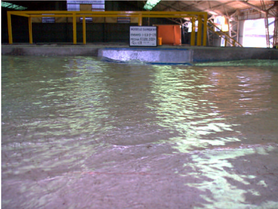
FOTO N° 3: Vista del funcionamiento del sumidero (PL=0.5%, PT=2% y Q=120 lt/s)
