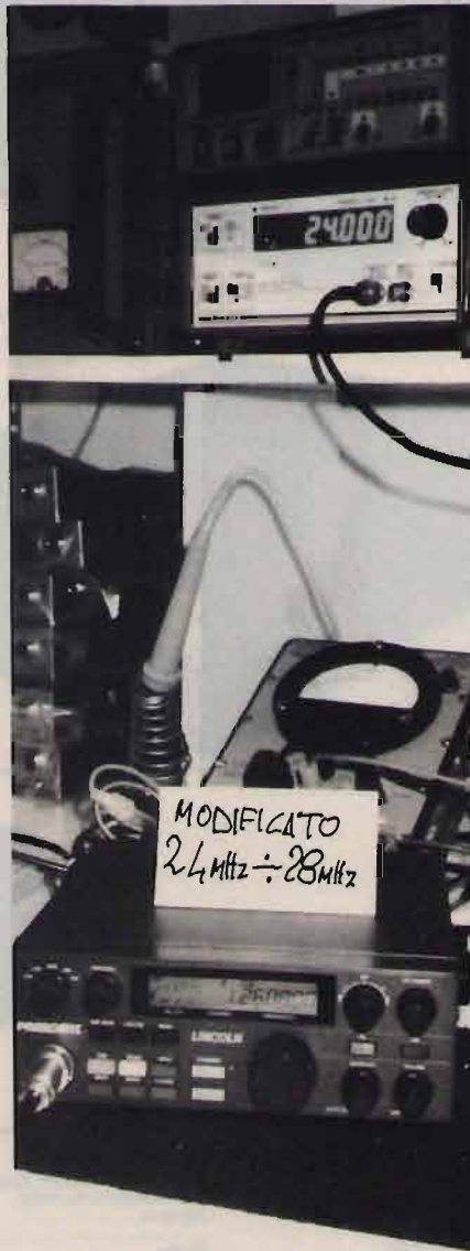
Si noti la frequenza letta sul Lincoln (26 MHz) e quella letta sul frequenzimetro in alto (24 MHz).
