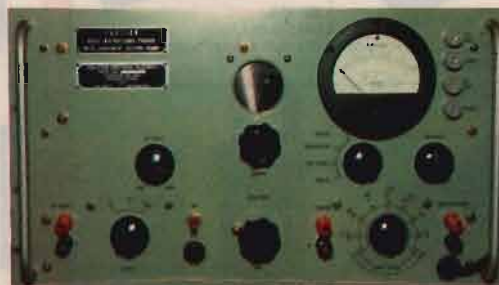
SPECTROM ANALYZER TS 723 D/U - Strumento per misurare la banda passante su segnali radio in BF.
