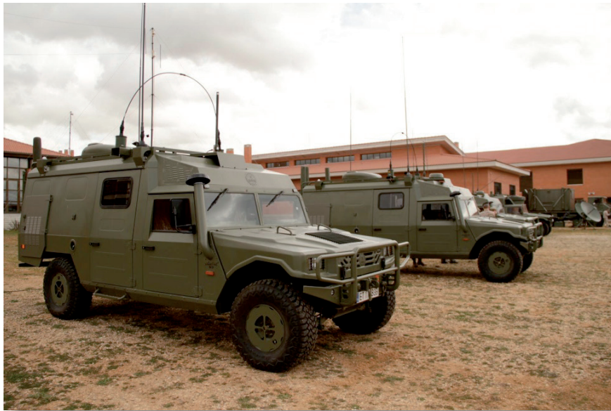
Figura 3. Estaciones PC-BON del ET con antenas de HF Chelton e Invelco AT-110
