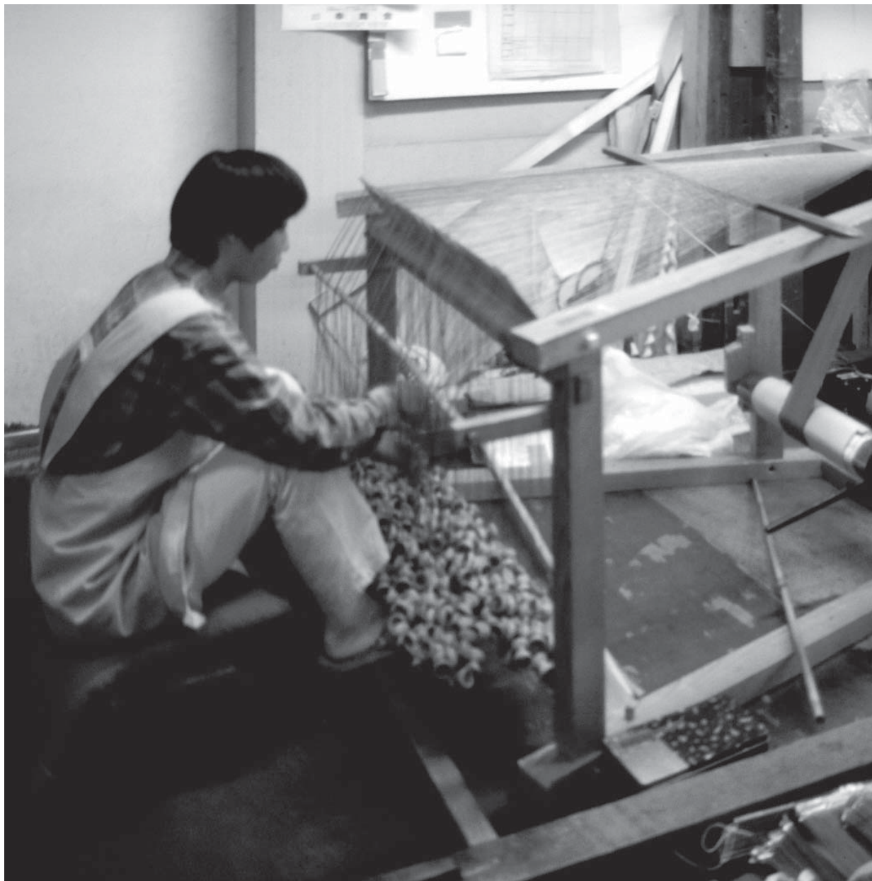
Væv af ayatake-gumi-no-dai-type til fremstilling af de meget faste, mønstrede ayatake-tekstiler, som anvendes til berre-obier. På billedet sidder pigen bag væven, hvis ergonomiske design står ikke mål med Hinayas tekstildesign
