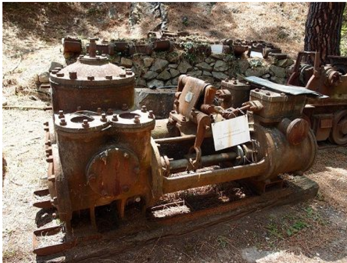
(p) Pompa per tirar l'aiga dins lei minas de carbon (19 en ) – Mina de Ròchabèla – Alès (30)
