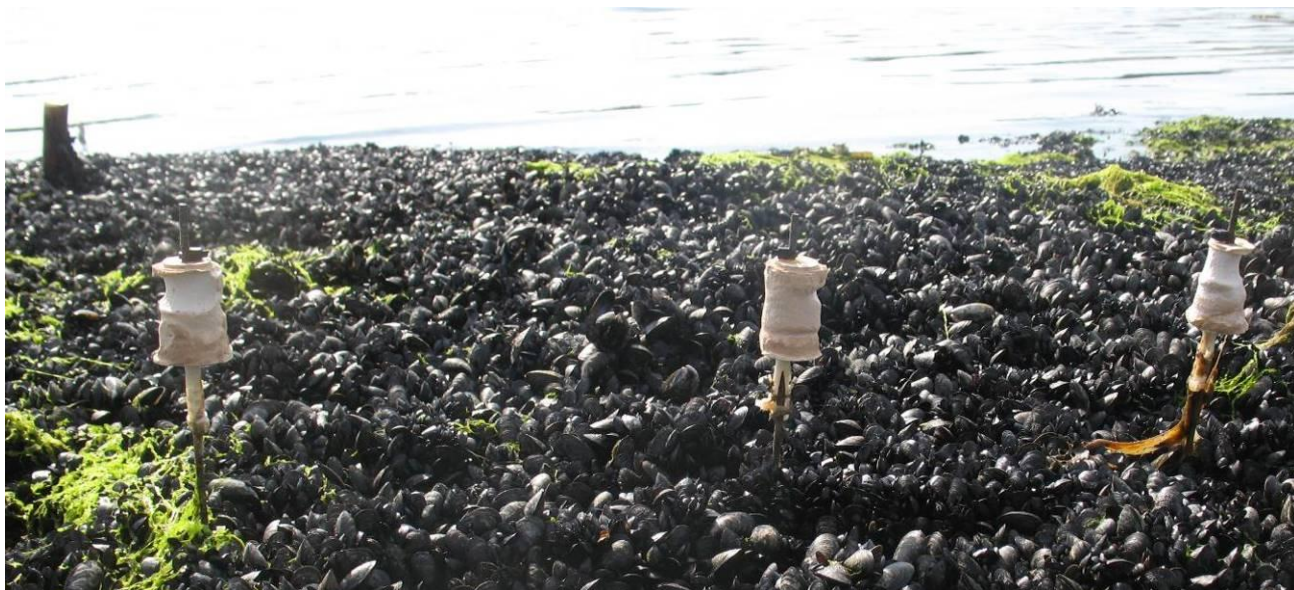
Рис. 42. Гипсовые цилиндры, установленные на литорали. По степени размывания гипса определяется уровень гидродинамической напряженности. Фото В. М. Хайтова.
