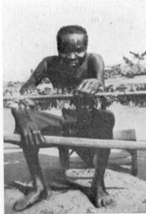
Le tisserand présente de la main gauche le « Masèle », écarteur de fils; de la droite le « Ngwen- si », navette.
