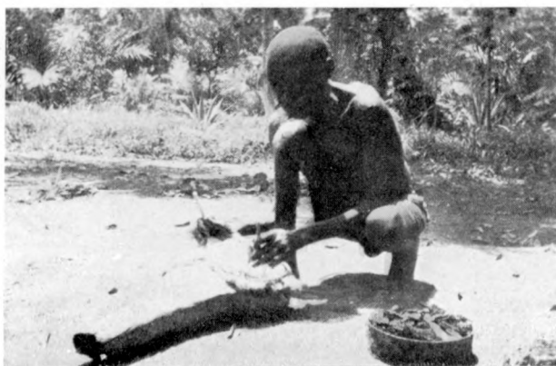
Soufflet de forge « Misesi » actionné par deux recouvrements de peau souple, traversés par des manches de bois.
