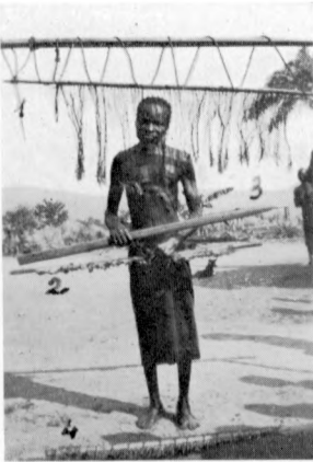
Métier à tisser musongo. 1. Porteur de fils de chaîne, « Nsùn ». 2. Écarteur de fils, « Ma- sak » ou « Masèl ». 3. Navette, « Ngwensi ». 4. Porteur inférieur de fils de chaîne, « Kuba ».
