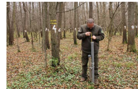
A talajkút vizállásának leolvasása heti feladat
