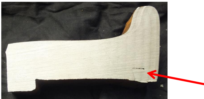
10. ábra: a sérült kerékabroncs metszete
