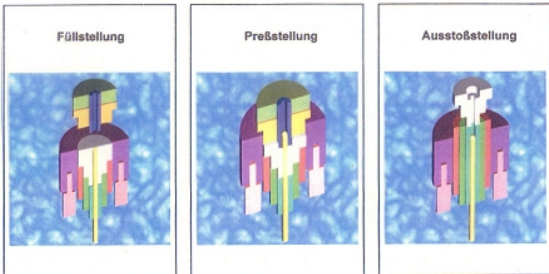
Bild 7: Hauptschritte beim Trockenpressvorgang
