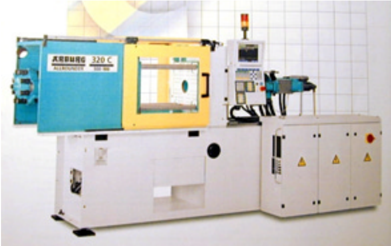
Bild 17: Spritzgussmaschine der Fa. Arburg wie sie bei der Herstellung von Keramikbauteilen zum Einsatz kommt
