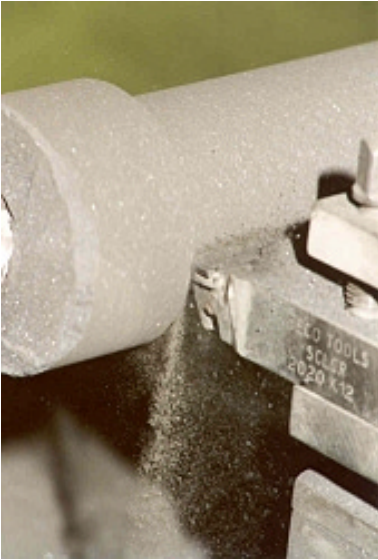
Bild 10 und 11: Grünbearbeitung von istostatisch gepressten Rohlingen
