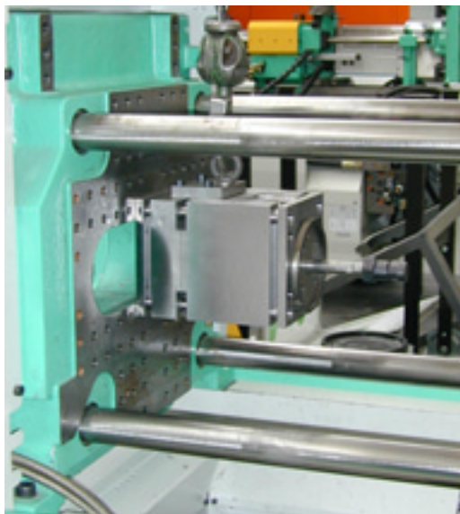
Bild 18: Einbau eines Spritzgusswerkzeugs
