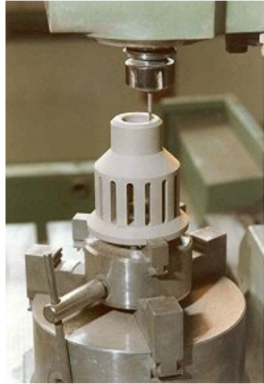
Bild 10 und 11: Grünbearbeitung von istostatisch gepressten Rohlingen
