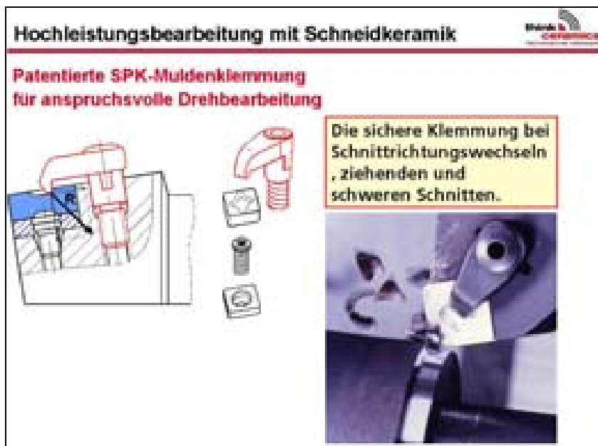
Bild 9: Patentierte SPK-Muldenklemmung für einen sicheren Drehvorgang
