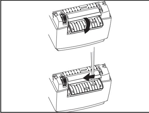
Der optionale Spender ermöglicht das Drucken im „Abziehmodus“ (Peel), in dem die Rückenbeschichtung des Etiketts separiert wird und die Etiketten einzeln zur sofortigen Platzierung präsentiert werden.
