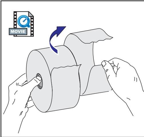
Die Rollenmedien werden auf die gleiche Weise im Drucker installiert, egal ob sie nach innen oder außen aufgewickelt werden.
