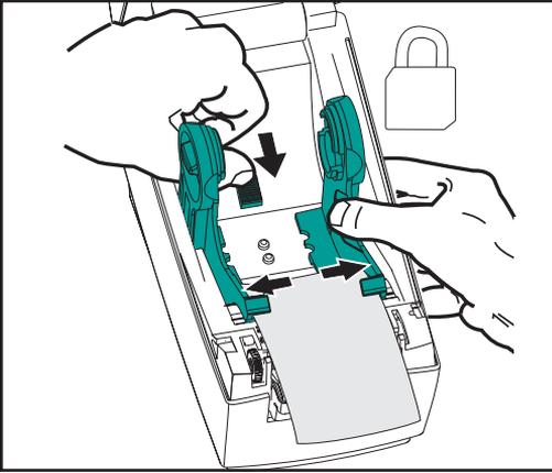
Zum Druck auf Endlosmedien müssen beide Medienaufhänger und die Medienführungen korrekt positioniert werden.
