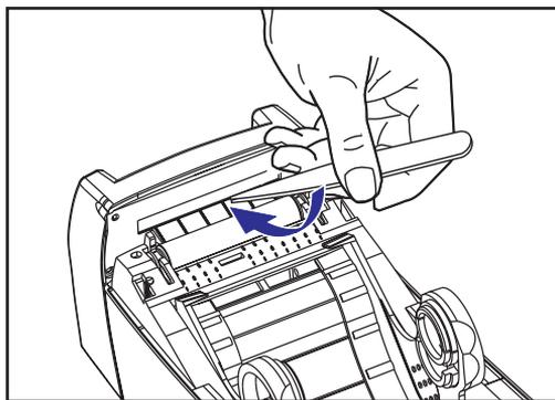
Wenn die Klinge Etiketten durchschneidet, kann der Mediencutter durch Kleber verklemt werden.
