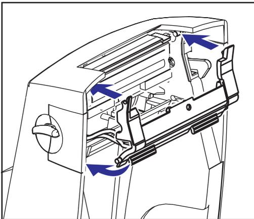
Legen Sie die Medien wieder ein. Stecken Sie das Netzkabel ein, schalten Sie den Drucker ein und drucken Sie einen Statusbericht aus, um die ordnungsgemäße Funktion zu überprüfen.
