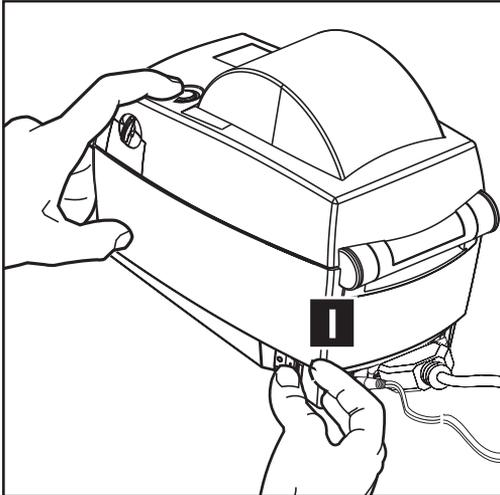
Führen Sie nach dem Laden der Medien die folgenden Verfahren zum Messen der Länge jedes Etiketts oder Tags aus. Stellen Sie sicher, dass die obere Abdeckung des Druckers geschlossen ist.
