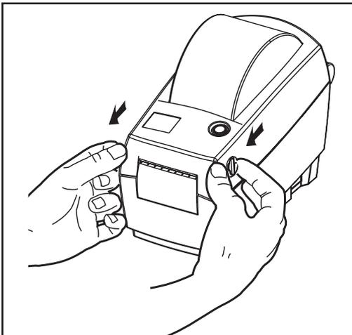
Um Zugang zum Medienfach zu erhalten, müssen Sie den Drucker öffnen.
