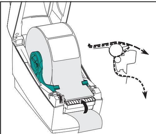
Während des Druckauftrags zieht der Drucker die Rückenbeschichtung ab und präsentiert ein einzelnes Etikett. Wenn Sie das präsentierte Etikett abnehmen, druckt der Drucker das nächste Etikett.
