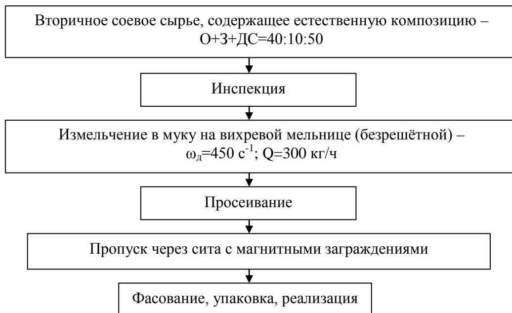
Рис. 1. Технологическая схема производства соевой белково-углеводной муки из вторичного соевого сырья: О – оболочка; З – зародыш; ДС – дробленые семена
