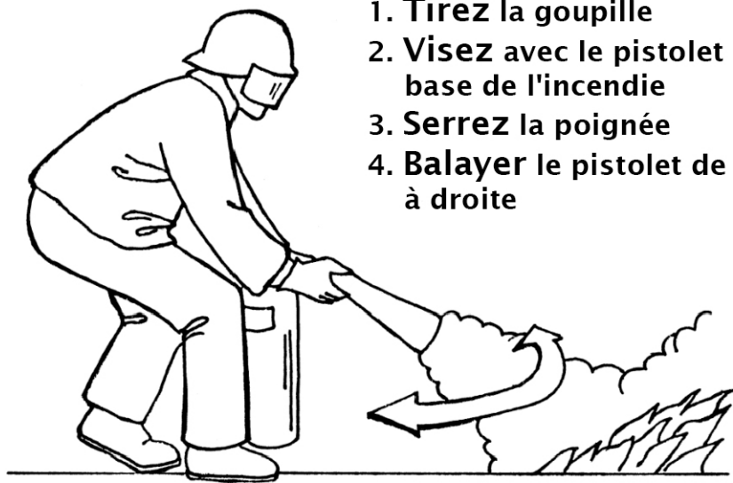
Image 20-10 Les quatre étapes pour utiliser un extincteur . Image reproduite avec l'aimable autorisation d'AMSEA.
