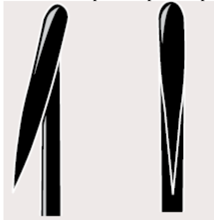
Image 12-5 Hameçon à courbure désaxée (gauche) et hameçon à courbure dans l'axe. Image extraite de Beverly (2009).
