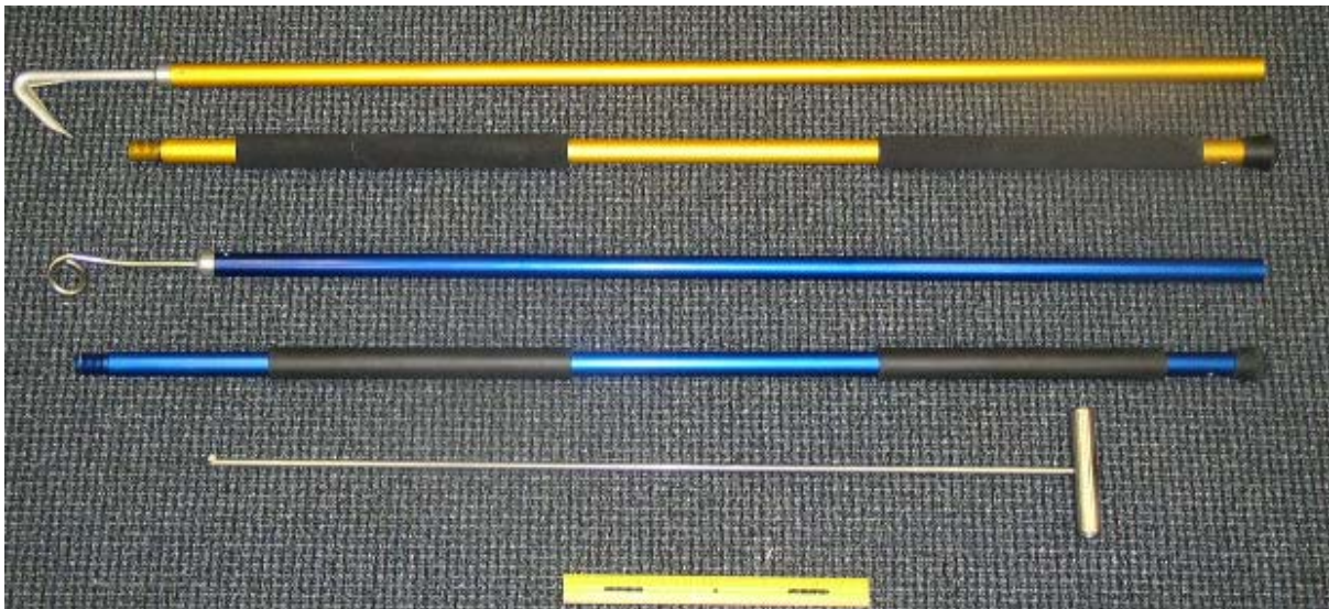
Image 16-1 Équipement à long manche : Coupe-lignes (au dessus), dispositif d'extraction en queue de cochon (au milieu) et dispositif en J (en bas). Images extraites de PIRO (2009).
