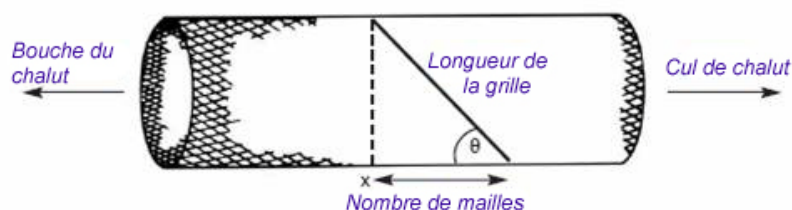
Image 7-6 Schéma de l'angle de la grille (Eayrs 2007).
