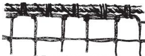
Image 6-7 Mailles montées en losange (en haut) et en carrée (en bas). Schéma extrait de (NMFS 2007b).
