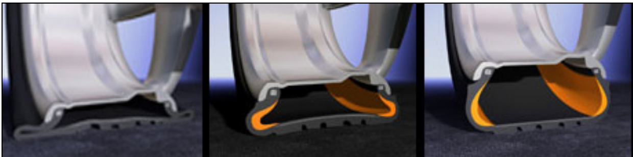
Bild 1: Konventioneller Reifen nach Druckverlust: Reifen wird nach wenigen Umrrollungen zerstört Bild 2: Reifen mit CSR nach Luftverlust: Aktionsradius bis zu 80 km bei 80 km/h max. Geschwindigkeit Bild 3: SSR Reifen im Normalbetrieb
