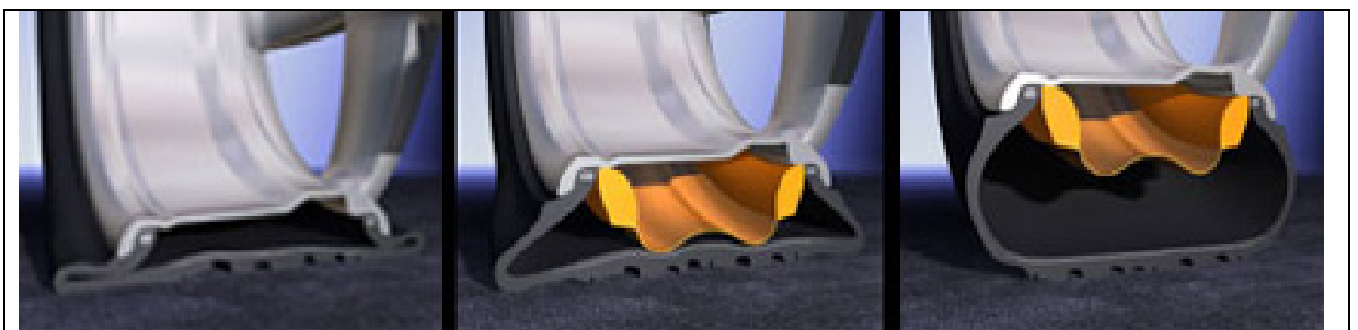
Bild 1: Konventioneller Reifen nach Druckverlust: Reifen wird nach wenigen Umrrollungen zerstört Bild 2: Reifen mit CSR nach Luftverlust: Aktionsradius bis zu 200km bei 80km/h max. Geschwindigkeit Bild 3: Reifen mit CSR: Kein Einfluss auf die Reifenperformance
