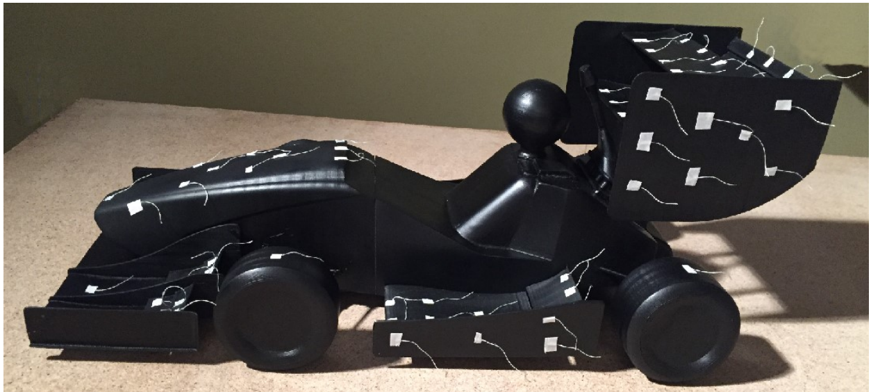
Rys. 26. Model gotowy do testów przy pomocy nici.
