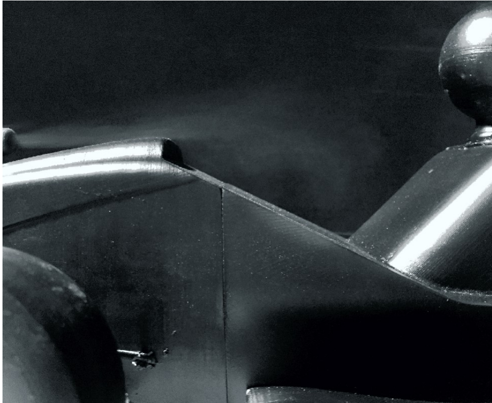
Rys. 25. Przepływ na granicy poszycia i przestrzeni kierowcy z widocznym przepływem turbulentnym
