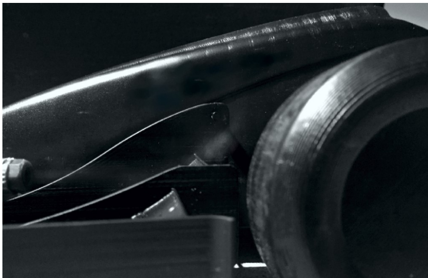
Rys. 24. Przepływ dymu przy najwyższym położonym płacie wewnętrznej sekcji skrzydła przedniego
