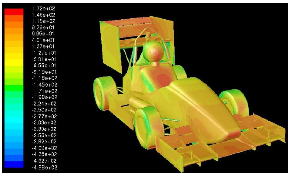
Rys. 13. Rozkład ciśnienia statycznego na samochodzie AGH RT 6.0
