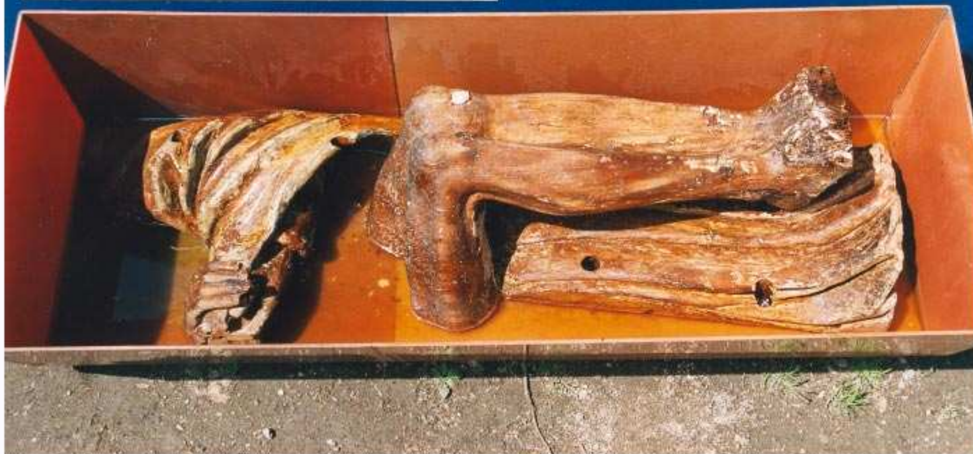
V petrifikační lázni SOLAKRYLu BMX v toluenu
