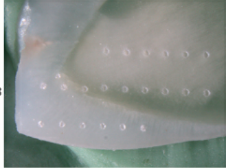
FELによる歯の切削 (2.94 μm)
