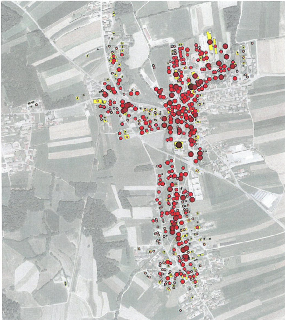
Slika 19: Prikaz razporeditve letnih koristi po objektih (pričakovana korist kot zmanjšanje poplavnih škod).
