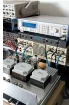
Aliasing-Verzerrungsmessung an einem CD-Spielers
