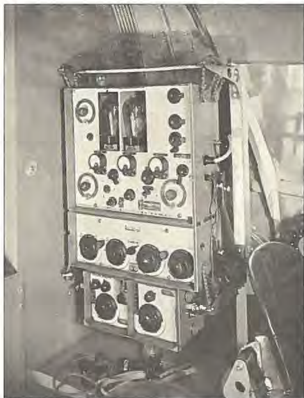
Marconi kombineret Mellem- og Kortbølgesender med „Homing“ Anordning.
