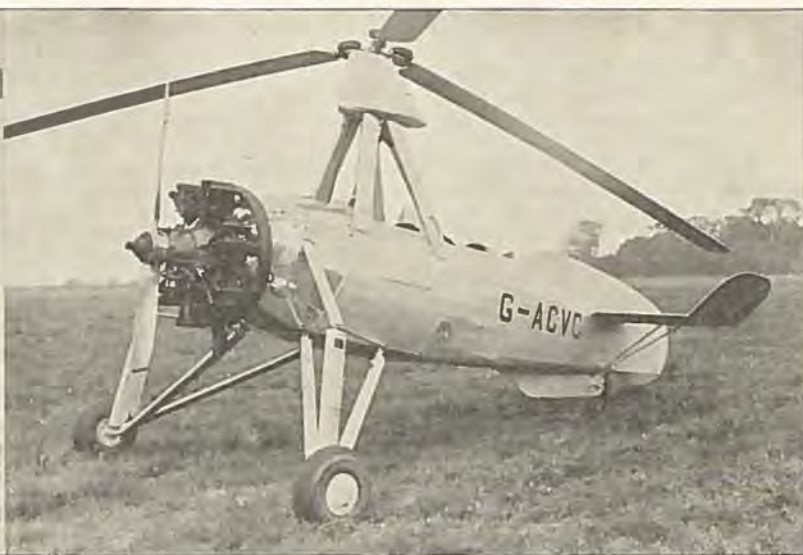
Typen C 30 har en 140 H.K. Siddeley „Genet Major“ Motor.
