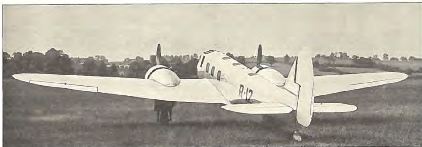
Typen er oprindelig bygget som civil Flyvemaskine; men Royal Air Force har bestilt et større Antal til Anvendelse som Bombeflyvemaskiner. Dens største Hastighed er 428 km/T. Den er bygget af Metal.
