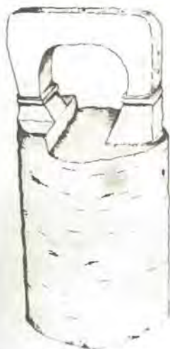
Kammer af bronze fra Store Sophia. Dette løse kammerstykke fra en af skibets få bagladedekanoner har en længde på 17 cm og en diameter på 11,7 cm. Kammeret er ladet med blykugler. Sjøfartsmuseet i Göteborg. Tuschtegning af Frank Rasmussen.
