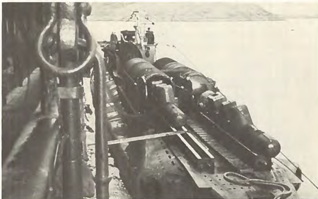
Den engelske kopi af »Maiale«, –Human Torpedo MK. 1 – kaldet »Chariots«, ombord på ubåd med to containere på agterdækket.
