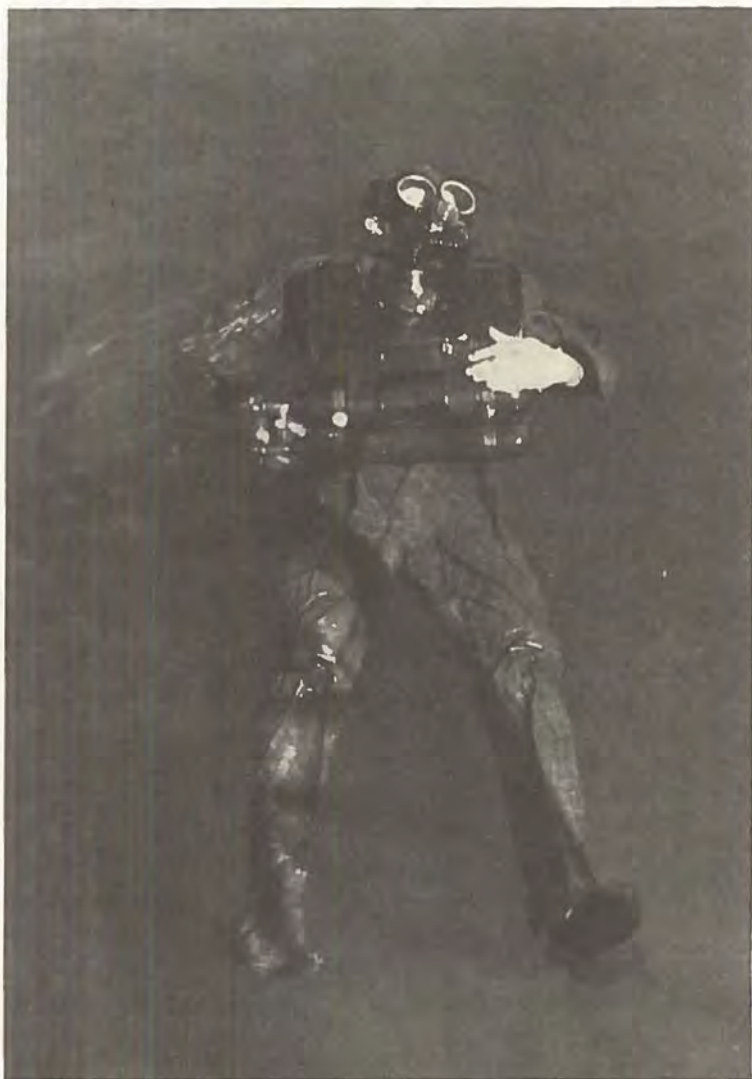
Italiensk dykkerudstyr for torpedomandskab. De to iltflasker gav mulighed for flere timers dykning. Udstyret var lavet af Pirelli og blev anset for det bedste under krigen. Bemærk, at torpedorytterne ikke bar svømmefødder.
