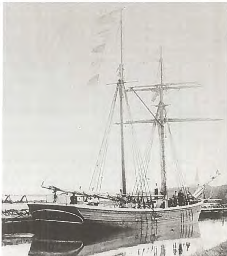
Den tomastede topsejlskonvert Luna i Bogense havn. Fartøjet var på 123 BRT og havde C. J. Jensen i Troense som reder. (Søfartsarkivet på Svendborg og Omegns Museum).
