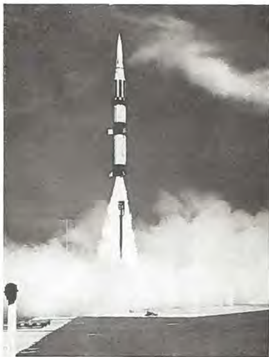
PERSHING raketten har en hastighed på 10 gange lydens og en rækkevidde på ca. 1000 km.
