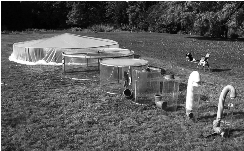
1. ábra • Növekvő mintavételi egységek: 7,5 cm-től 480 cm-ig duplázódik a gázcseremérő kamrák átmérője
