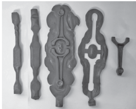
Figura 3.16 Etapas de forjamento em matriz para fabricação de uma biela. Comprimento da biela: ≈ 20 cm.
