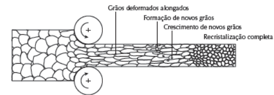
Figura 3.7 Ilustração esquemática das mudanças na morfologia e no tamanho dos grãos do metal durante a laminação a quente.
