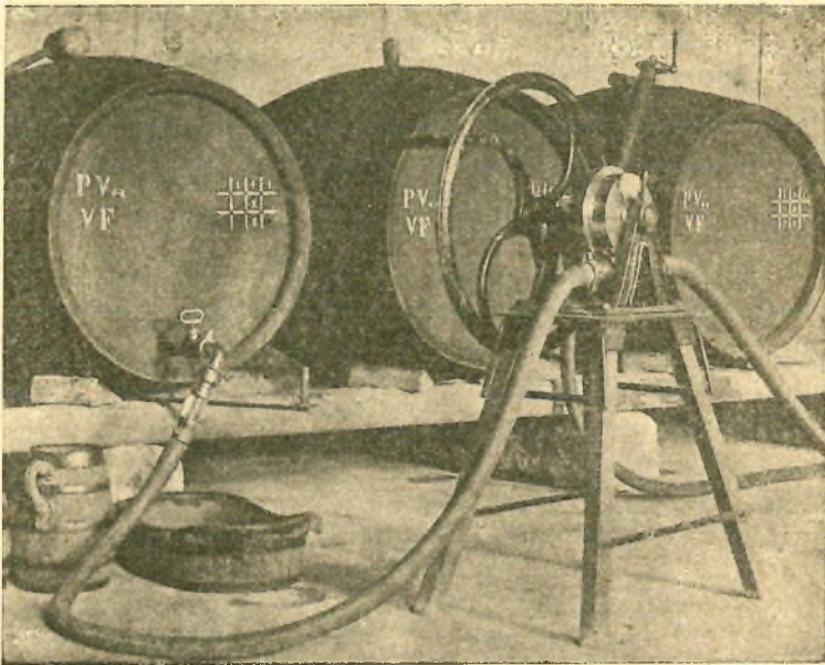
43. ábra. A kőforgós fejtőgép csővezetékekkel, zárt fejtéshez előkészítve.
