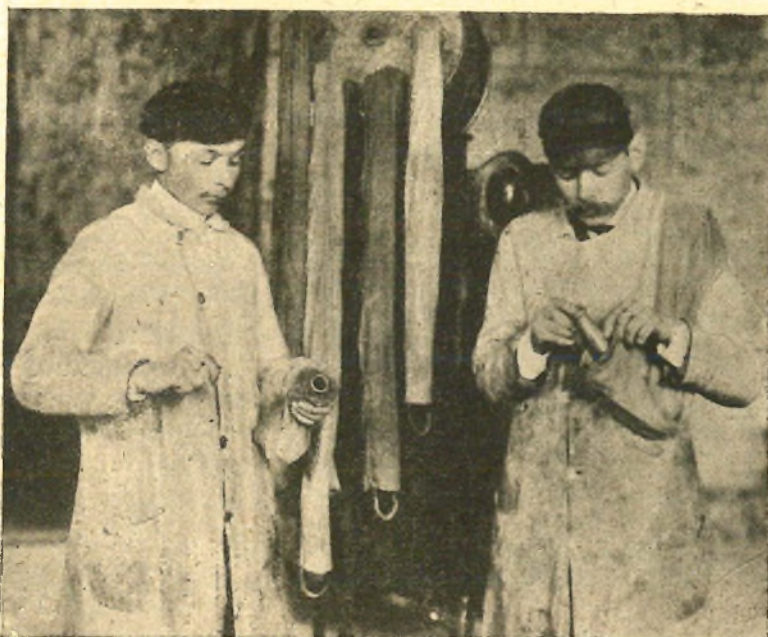
58. ábra. A hollandi szűrő zsákjainak a harangoeskákra kötése.
