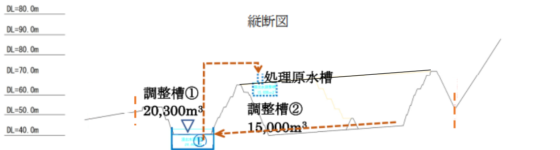
図 2.5.25 浸出水調整槽配置縦断面図
