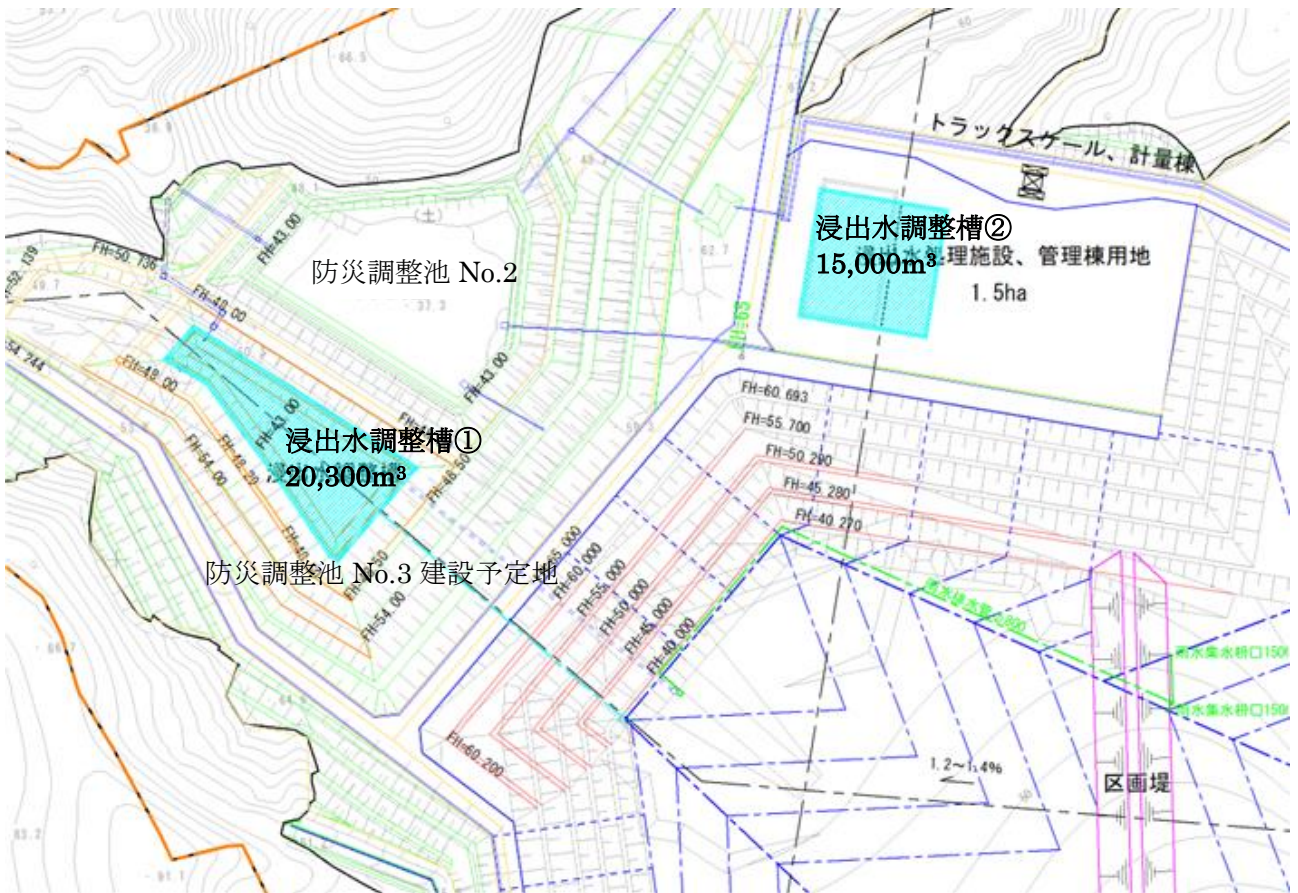
図 2.5.24 浸出水調整槽配置平面図
