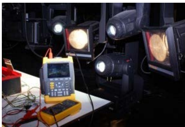
2.ábra: A Masat-1 napelemeinek tesztelése a Budapesti Operettszínház színpadán [3]
