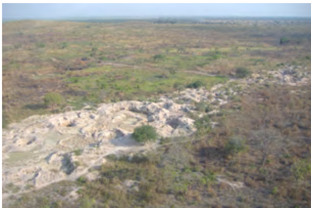
Site de Manono, corps pegmatitique altéré exploité par des artisans. La partie blanche (en clair) provient du minéral kaolin, produit par l'altération de minerais primaires (feldspath, spodumène, muscovite, etc.).
