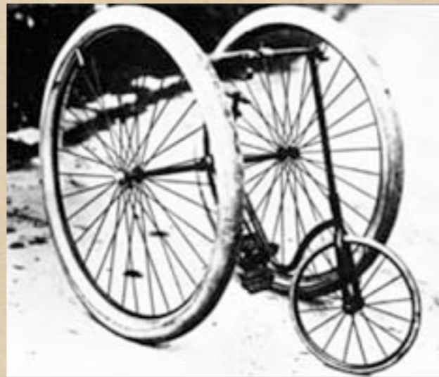
Johnny's Dreirad Für das Dreirad seines Johnny konstruiert John Boyd Dunlop die ersten Luftreifen für den praktischen Einsatz.
