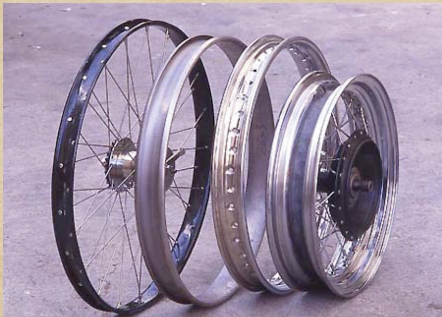
Zwei Wulst-Felgen, Standard-Tiefbettfelge, Tiefbettfelge für Breitreifen
