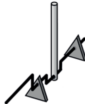
Figuur 6: Verskillende meganismes waaruit jy kan kies om rotasiebeweging in wederkerende beweging te verander
