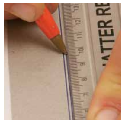
Figuur 19: Maak 'n vou deur eers twee groewe aan die binnekant te maak.
