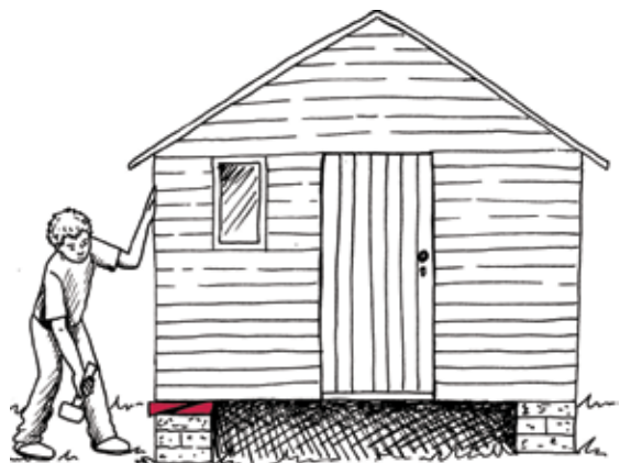
Figuur 9: Wîe kan gebruik word om swaar voorwerpe, selfs huise, op te lig!
