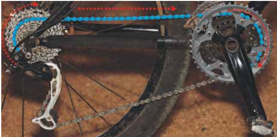
Figuur 12: Die agterwiel van 'n fiets word deur die rat-en-kettingmeganisme aangedryf.
