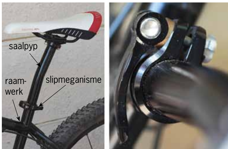
Figuur 12: 'n Slipmeganisme word gebruik om die saalpyl aan die raamwerk van hierdie fiets vas te klamp.
