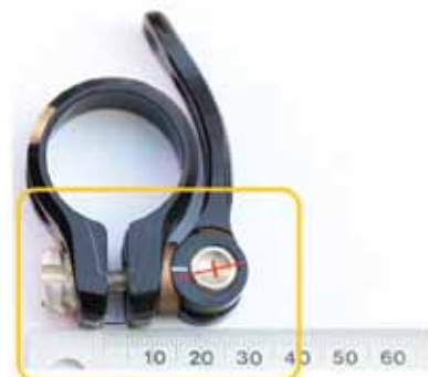
Figuur 13: Die sye van hierdie slipmeganisme beweeg of klem nouer saam as die eksentrieknok met die handvat gedraai word.
