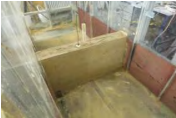
Abbildung 26: In den Deichkörper integrierter Kern aus verfestigtem und stabilisierendem Mineralstoffgemisch incl. Wassergehaltssensor und Pegelrohr
