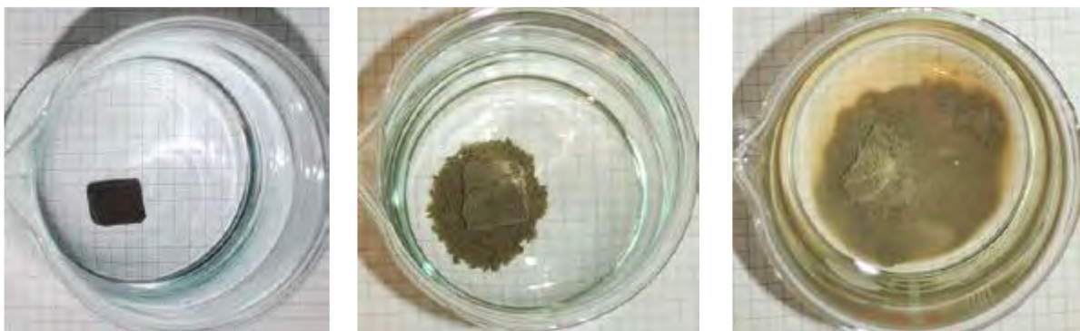
Abbildung 33: Beispiele für verschiedene Dispersionsgrade nach ASTM D6572 – 13 (2013a) – Grad 1, nicht dispersiv (A), Grad 2, mittel dispersiv (B), Grad 4, stark dispersiv (C)
