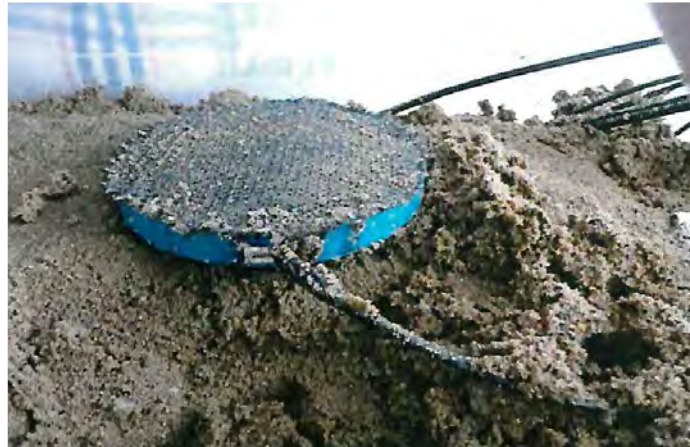
Abbildung 41: Konfektionierte Messtablette im Mineralgemisch
