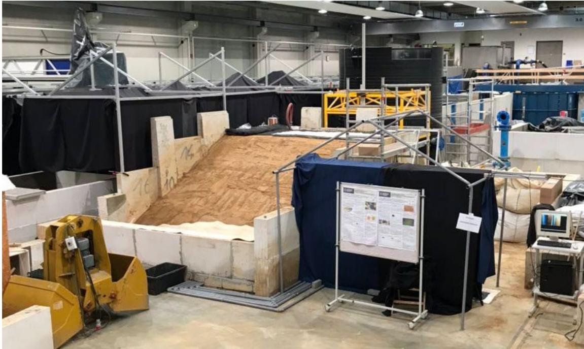
**Abbildung 2.2** – Versuchsstand nach Fertigstellung der Deichkubatur GS01
