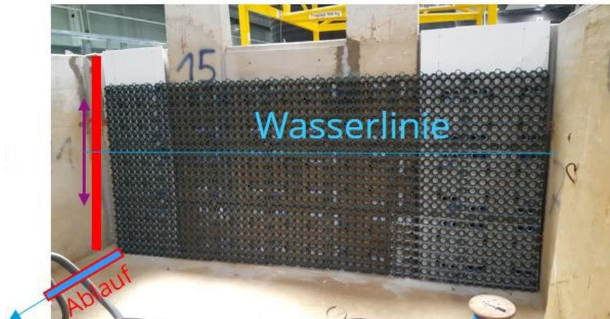
**Abbildung 3.10** – Funktionsweise der Einstauregelung mit Drainagewand (hier ohne vorgesetztes Filtertextil, Zulauf über Pumpe im rückwärtigen Bereich)
