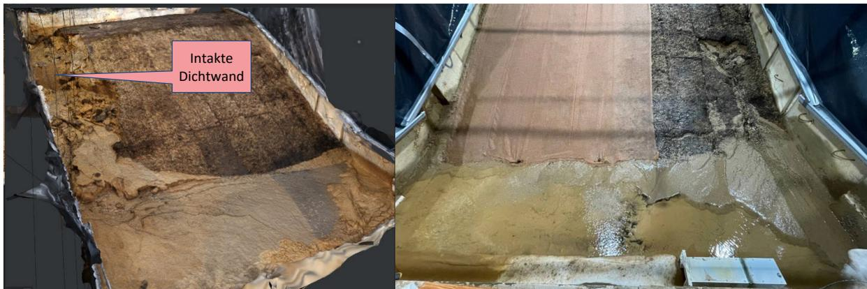
**Abbildung 3.12** – Partielles Deichversagen im Zusammenhang mit der Niederschlagssimulation
