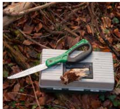
Figure 109 : Petite scie à main permettant le prélèvement de branches ou morceaux de bois © Y. Sellier
