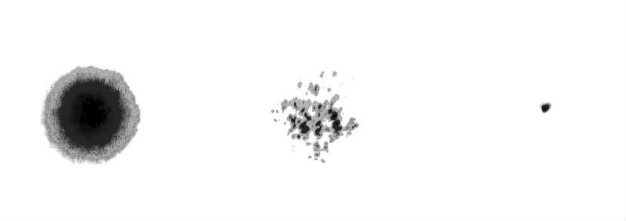
Rysunek 3.3: Obraz gwiazdy zniekształcony wpływem atmosfery dla długiego (lewo) i krótkiego (środek) czasu integracji. Po prawej obraz poprawiony przez system AO ( Center for Adaptive Optics ).
